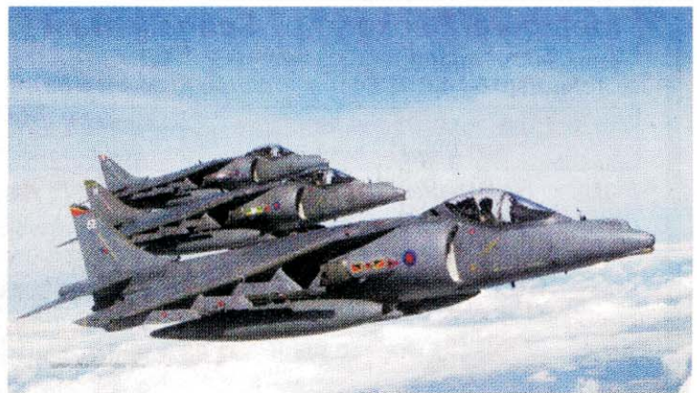
Der britische Kampffjet „Harrier“ kann senkrecht starten und landen, in der Luft stehen bleiben und rückwärts wie seitwärts fliegen.
